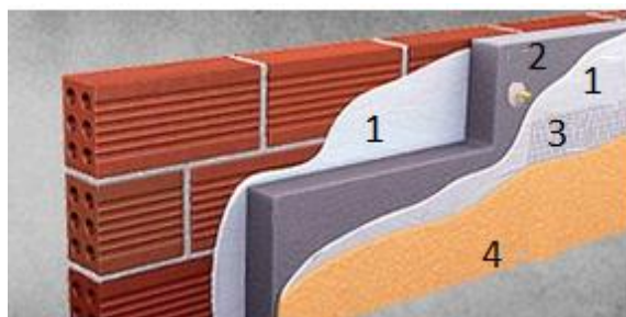
Εικόνα 2: Στάδια εφαρμογής εξωτερικής θερμομόνωσης.
